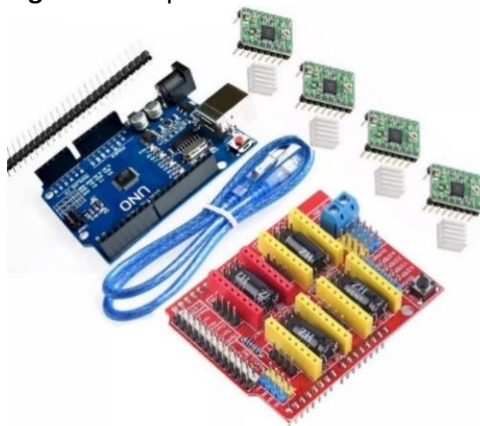
Figura 5 Componentes del sistema electrónico de la máquina CNC router artesanal
